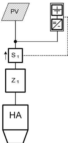
Diese Anschlussvariante beschreibt das Prinzip der Volleinspeisung. Die Einbindung des Speichers ist im AC oder DC-Pfad möglich. Der Sensor S1 erfasst den gleichen Leistungsfluss wie der Zähler Z1.
