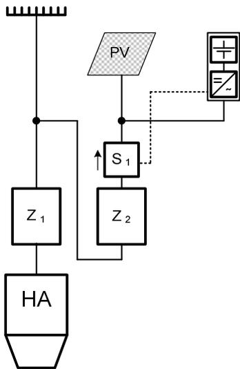
Bei dieser Variante ist der Speicher fest mit der EZA gekoppelt und wird gemeinsam mit dieser EZA über den Zähler Z2 gemessen. Die Einbindung des Speichers ist im AC oder DC-Pfad möglich. Der Sensor S1 erfasst den gleichen Leistungsfluss wie der Zähler Z2.
