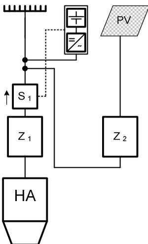
Bei dieser Variante ist der Speicher nicht fest mit der EZA gekoppelt. Der Sensor S1 erfasst den gleichen Leistungsfluss wie der Zähler Z1.
